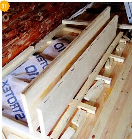
↑ Перед сплачиванием очередных элементов щита в их стыкуемых кромках выбрал пазы под шпонки-бисквиты. Вайму подготовил к выполнению операции: выставил продольный упорный брусок и в месте нового стыка поверх поперечных брусков застелил плёнку, чтобы не испачкать клеем пол.
