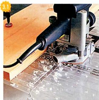
**3.1** Толстые листы сотового поликарбоната раскраивают на заготовки длиной 1 200 мм. С шагом 300 мм в них выбирают клиновидные пазы поперёк внутренних рёбер.
