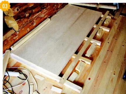
↑ ...промазал клеем пазы другого элемента и стыкуемые кромки. Затем состыковал элементы, уложив их на нижний ряд поперечных брусков ваймы. Делать это нужно быстро, пока клей не загустел.
