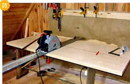
↑ В завершение готовый щит опилил в размеры дверного полотна.
