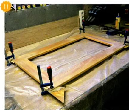
↑ Углы крышки для ящика соединены шпонками.
