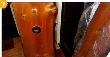
↑ Основа светильника для коридора — необрезная сосновая доска. Ручным фрезером в доске проделали отверстия под три светильника-спота.
